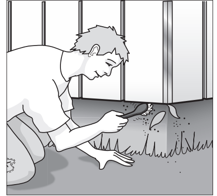
Kontrollér, at ventilationsåbning ved overgangen fra sokkel til facadebeklædning ikke er tilstoppet.
